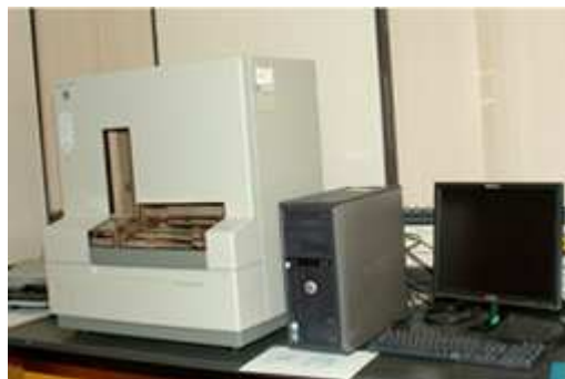
Figura 1: Máquina que fragmenta automáticamente, mediante enzimas el ADN
