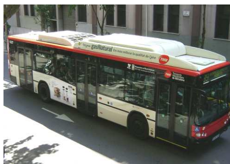
Figura 2 El 30% dels autobusos de Barcelona usen gas metà com a combustible. El dipòsit el porten al sostre
